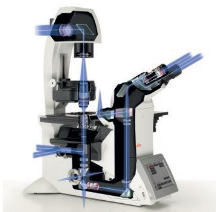
Optyczno-mechaniczny schemat portu infinity
